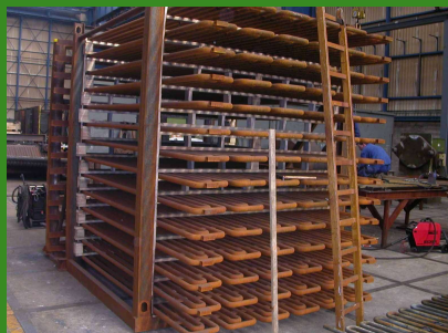
Sobreescalfador de la caldera
